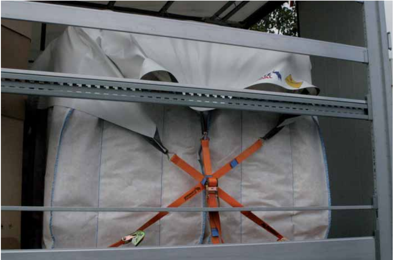
Sicherung eines IBC (Big Bag) mit Hilfe einer Plane. (Foto: Bernd Hohnstein)
