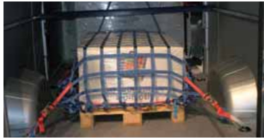
Ladungssicherung mit einem Netz (Foto: Bernd Hohnstein)
