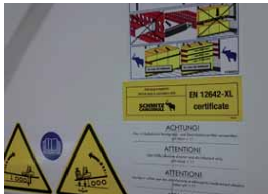
Kennzeichnung eines Aufbaus nach EN 12642 Code XL. (Foto: Bernd Hohnstein)
