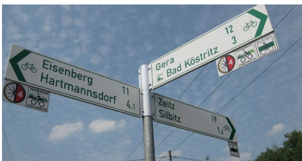
Abbildung 5.17 Höhenversetzte Montage erleichtert die Lesbarkeit
