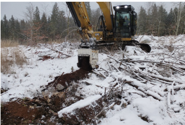
Bild 18: Streifenweise Flächenvorbereitung mit dem neu entwickelten KEM-ROC-Anbaufräskopf (EK 40 F). Von der Rückegasse aus wird mit einem Kettenbagger rechtwinklig zur Gasse ein 50 cm tiefer Frässtreifen, vergleichbar der Pein Plant, gezogen. Das Gehäuse verhindert das seitliche Auswerfen der Erde aus dem Frässtreifen. Das erzeugte optimale Pflanzbett eignet sich vor allem für stückzahlreiche Kulturen (z. B. Eiche) und erhöht den Anwuchserfolg der Pflanzen (Foto: Forstamt Bad Salzungen)
