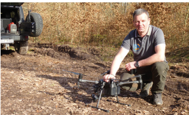
Bild 14: Profi-Flugdrohne der Firma Kummetat mit dem Firmeninhaber Marc Kummetat kurz vor dem Einsatz im Revier 08 Vitzeroode. Der Flugdrohne reichten „Lichtschächte“ von 10x10m im Buchenaltholz an einem Abfuhrweg zum gefahrlosen Aufstieg in die programmierte Arbeitsflughöhe (Foto: Forstamt Bad Salzungen)
