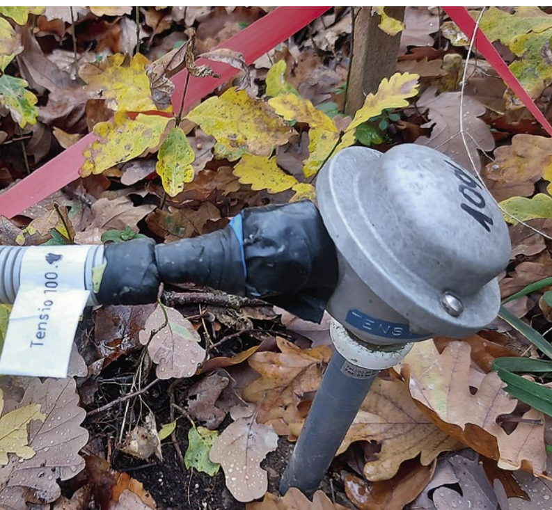
Bild 22/23: Messgeräte zur Bestimmung der Bodenfeuchte
